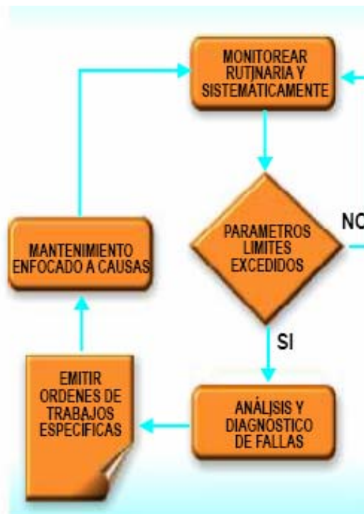
Figura 2.4: Proceso del Mantenimiento Basado en Condición.
