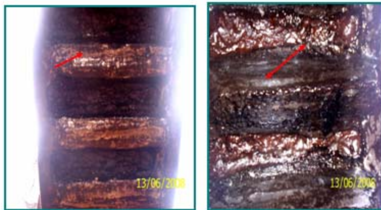
Figura 4.25. Desgaste acelerado y picado de los dientes de las cremalleras de los brazos del balde.
