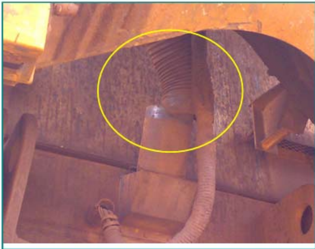
Figura 4.22. Ducto de ventilación del motor de excavación.
