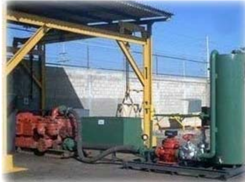
Figura 2.1. Banco de pruebas para bombas reciprocantes de VENMACA- Industria Metalúrgicas. [5]
