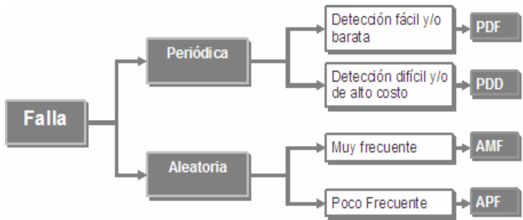
Figura N° 2.1: Clasificación de fallas
