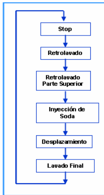
Figura 3.3. Diagrama de Regeneración Aniónico. Fuente: Filosofía de Operación Planta Desmineralizadora Unidad 770
