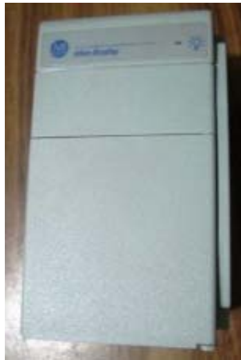
Figura 3.9. Fuente de Alimentación 1769-PA4. }
