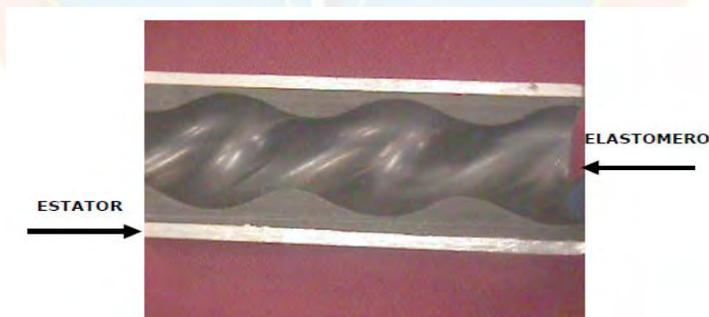
**Figura N° 2.3 Corte longitudinal de un estator**
