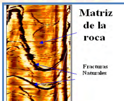
Figura N° 4.5 Registro de Imagen tomado en el Pozo-2.
