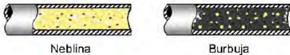
Figura 2.5 Flujo burbujas dispersas (Tipos)
