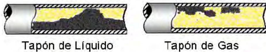
Figura 2.3 Flujo intermitente (Tipos)
