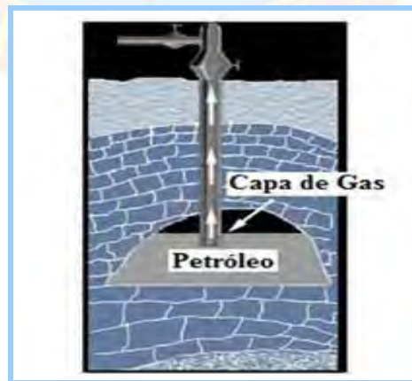
Figura 2.2. Esquema de un yacimiento con empuje por capa de gas (Escobar, 2005).
