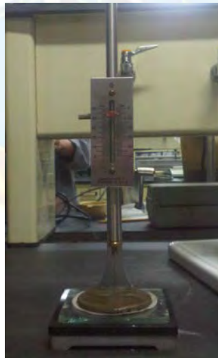
Figura A.4 Medición de espesor de revoque
