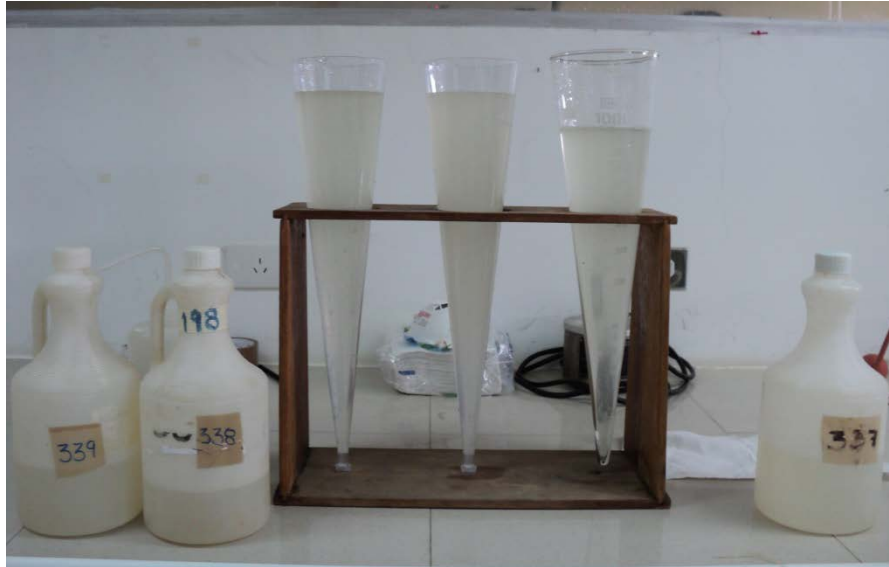
Figura E.15. Conos de plástico y vidrio, para la determinación de sólidos sedimentables, con sus respectivas muestras.
