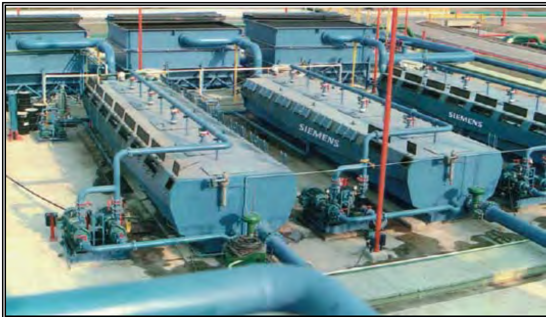
Figura 4.5 Separador por flotación de Gas Inducido (Fuente: presentación de tecnologías Siemens Water)
