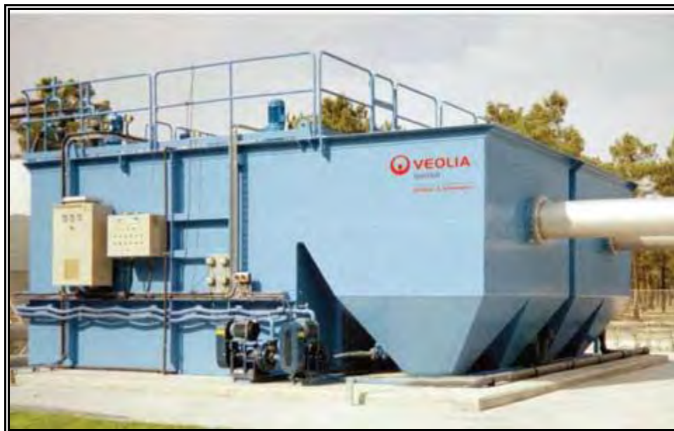
Figura 4.4 Separadores de flotación por aire Disuelto (D.A.F.) (Fuente: presentación de tecnologías Siemens Water)
