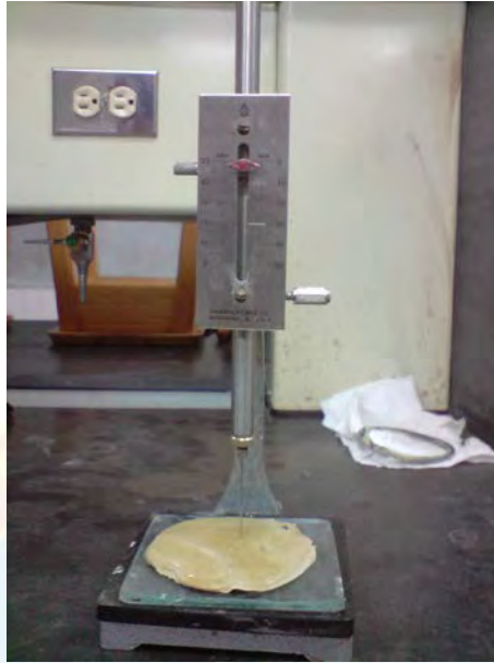
Figura N°D.9. Medición del espesor de revoque.
