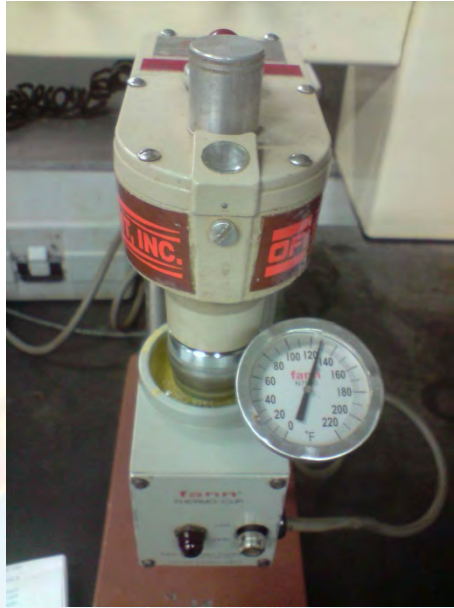
Figura N°D.7. Viscosímetro usado para determinación de las propiedades reológicas
