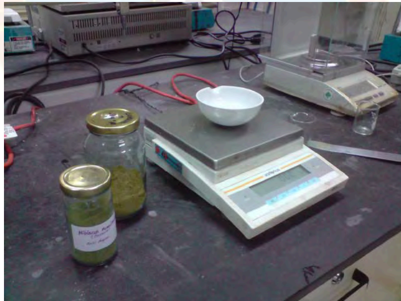
Figura N°D.4. Medición de los aditivos para la formulación del fluido. Fuente: Laboratorio de Perforación UDO-Monagas.
