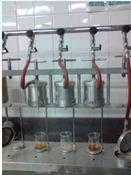
Figura N°D.8. Filtro prensa API por medio del cual se determino el volumen de filtrado del fluido.
