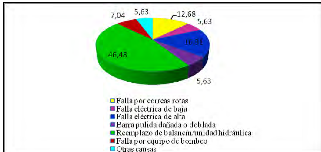
Gráfica 4.1 Porcentaje de las fallas o eventos del pozo por afectación de producción JOC-551
