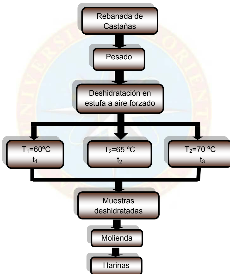
Figura 7. Esquema tecnológico para la elaboración de las harinas de castaña (Fase 2).
