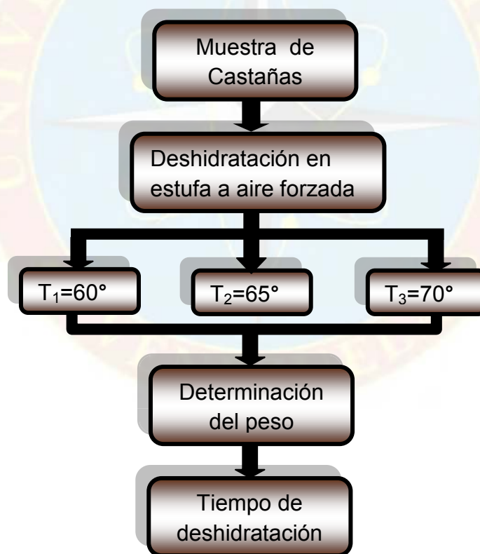
Figura 6. Determinación de los tiempos de deshidratación de muestra de castaña para cada temperatura (Fase 1).
