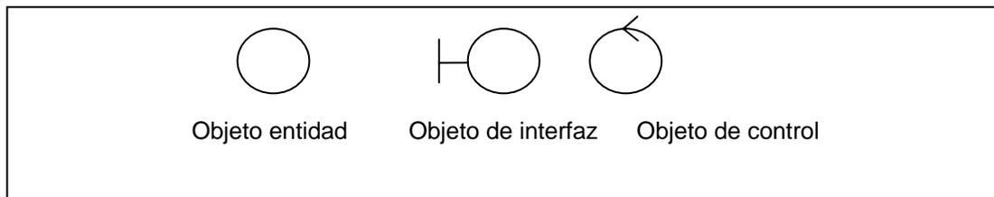
**Figura 10. Objetos Utilizados en el Modelo de Análisis.**
