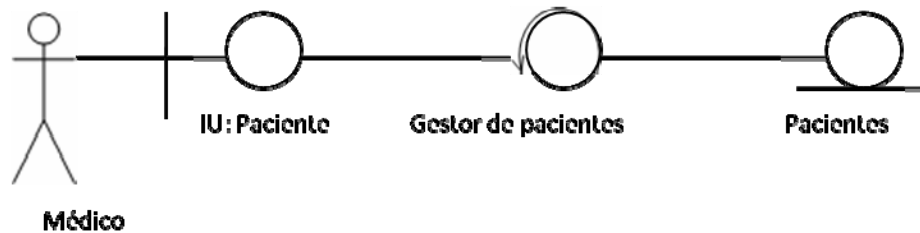
Figura 16. Diagrama de clases de análisis del caso de uso registrar datos personales.
