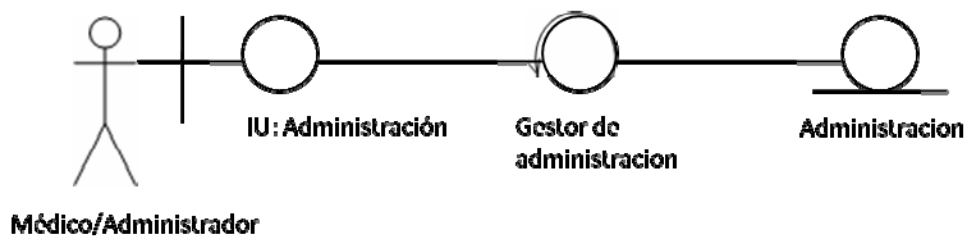
Figura 21. Diagrama de clases de análisis para el caso de uso registrar datos del médico e institución.
