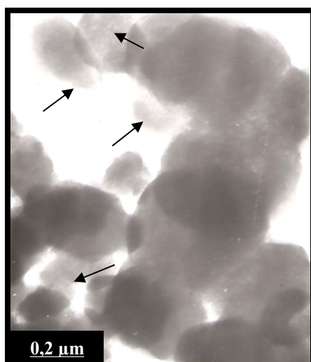
Figura 21. Micrografía del material MCM-41 puro de óxido de silicio.
