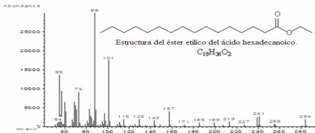
Figura 49. Espectro de masas del pico con TR 15,64 y área 4,47 asignado al éster etílico del ácido hexadecanoico.
