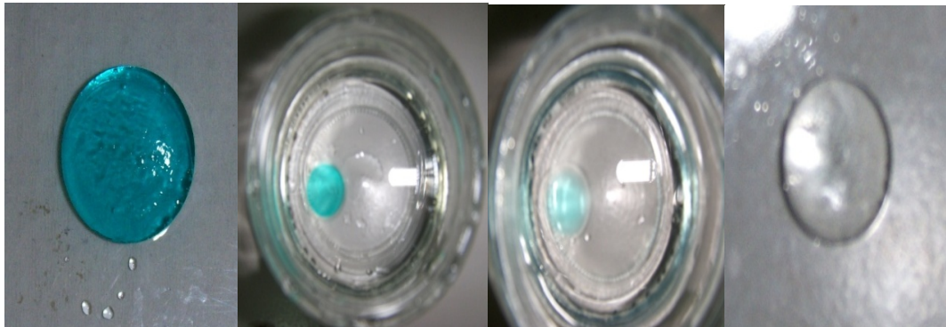
Figura 64. Desorción del hidrogel AAm/AAc 60/40 en una solución de HNO 3 después de haber estado sumergido en la sal de Cu 2+ .
