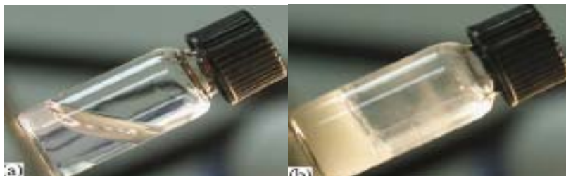
Figura 5. Imagen del hidrogel obtenido con poli(óxido de etileno) y poli(3-hidroxibutirato): (a) En estado líquido y (b) gelificado (Jun et al. ; 2006).
