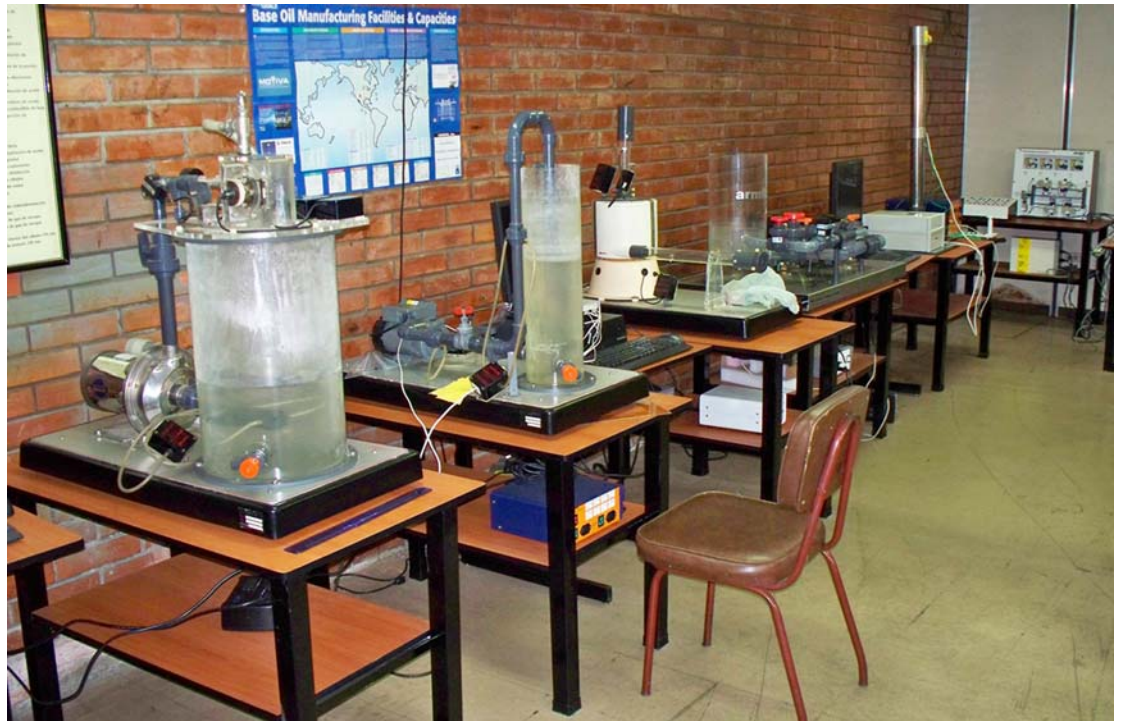
Sistema de control para un banco de pruebas de bombeo de fluido multifásico, que diseñó Yordi González con el apoyo de Irina Chinchilla, tesista del Centro de Termofluidodinámica y Mantenimiento del INDESA y del Departamento de Ingeniería Mecánica
