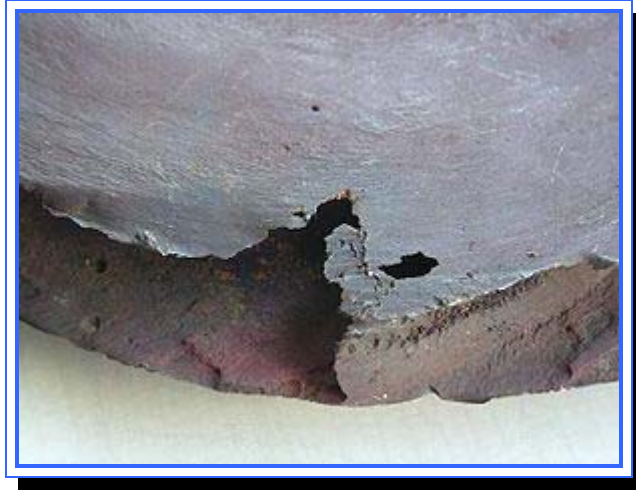
Figura 2.11: Efecto de la Cavitación.
