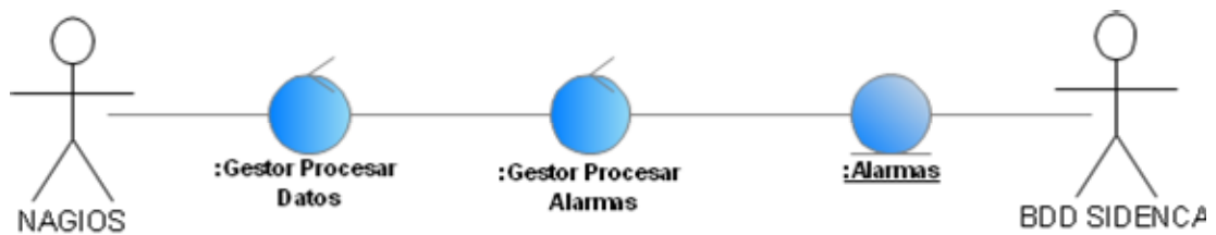
Figura 2. Diagrama de Clase de Analisis para el Caso de Uso Procesar Datos Alarmas.
