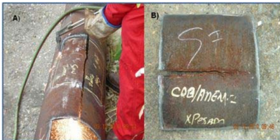
Figura 3. 4. A) Corte de la muestra de tubería en zona afectada B) Muestra enviada a INTEVEP para su análisis
