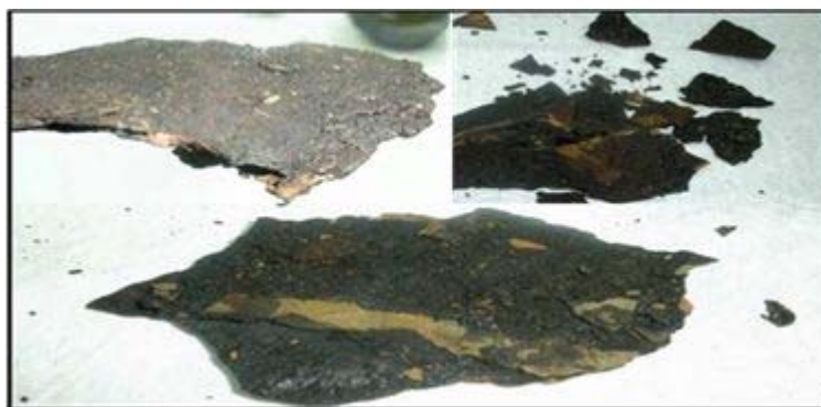
Figura 4.5. Depósitos hallados en la línea de tubería del COB al salto AREM2
