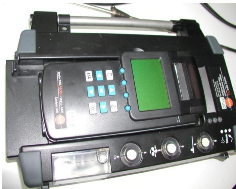
Figura 3.3 Analizador de gases (unidad de control de Testo).
