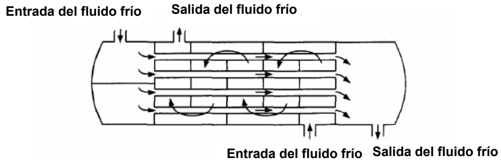
Figura 2.3. Intercambiador de calor de tubo y carcasa 1-1 (Geankoplis, 1998).
