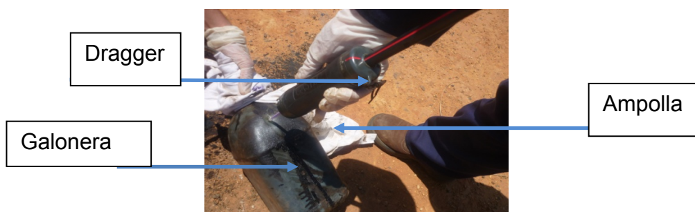
Figura 5. Medición de los gases H 2 S y CO 2 utilizando el Dragger
