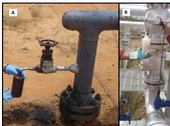
Figura 6. Toma de muestras en la tubería de producción (A. Cabezal de pozo y B. Quill en la llegada al múltiple)
