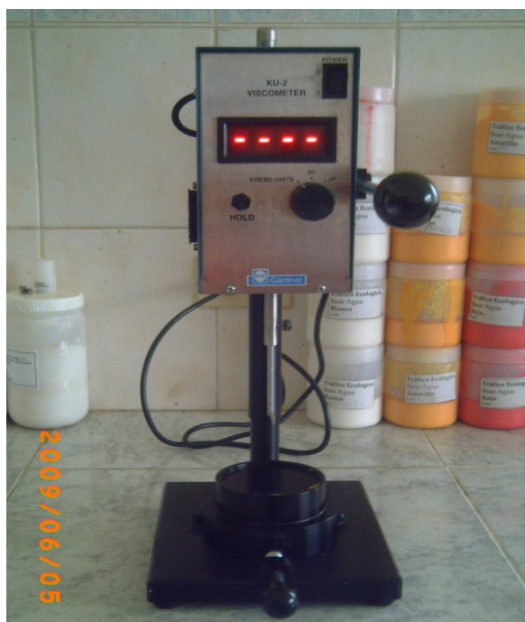
Figura 2.2 Viscosímetro Brookfield KU
