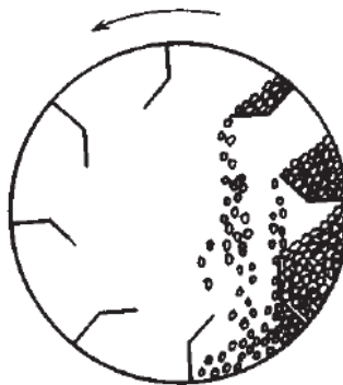
Figura 2.14 Lecho móvil dentro de un secador rotatorio con elevadores [8].
