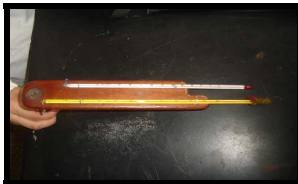
Figura 3.9 Psicrómetro utilizado para medir la temperatura de bulbo seco y húmedo
