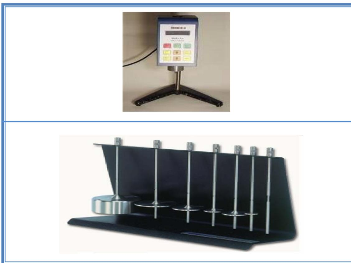
**Figura 3.3. Viscosímetro de Brookfield (a) y sus respectivas agujas (b).**
