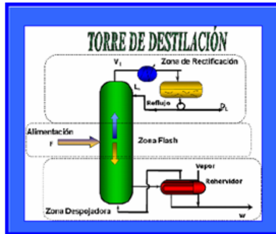
Figura 2.2. Esquema general de los elementos principales presentes en una torre de destilación.
