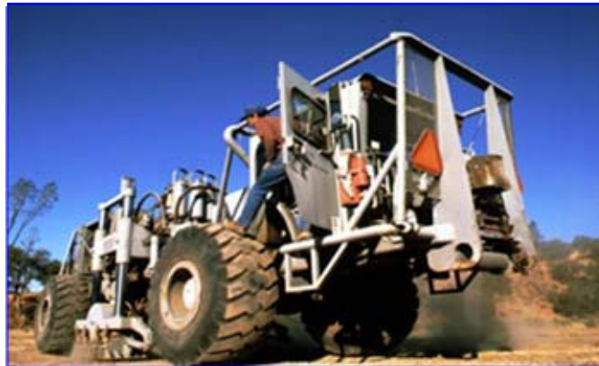
Figura 2.7 Camión Vibroseis, utilizado para la exploración de nuevos Yacimientos.
