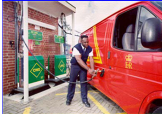
Figura 2.6 Estación de servicio de GNC.
