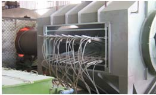
Figura 2.14 Aplicación de resina en tubo.
