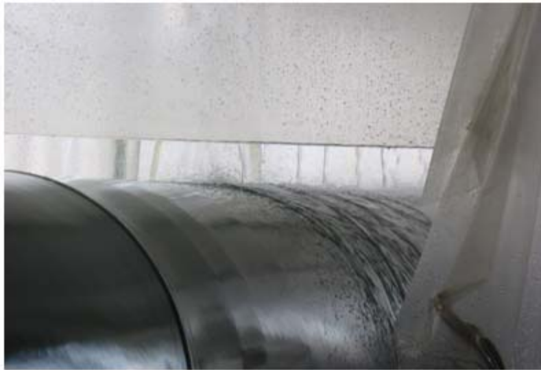
Figura 2.16 Lavado del tubo en la batea de enfriamiento.
