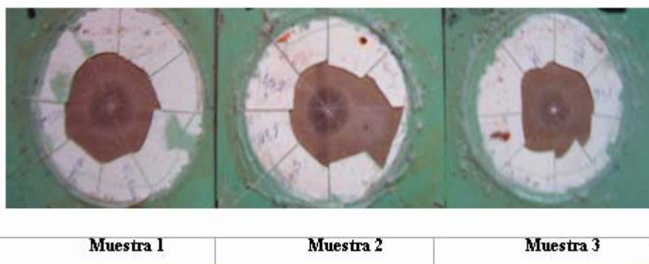
Figura 4.17 Fotos digitales de las probetas con espesor de revestimiento igual a 14 mp, después evaluar la pérdida de adherencia.
