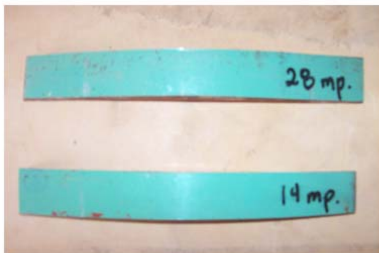
Figura 4.26 Probetas después de haber sido sometidas a doblez.
