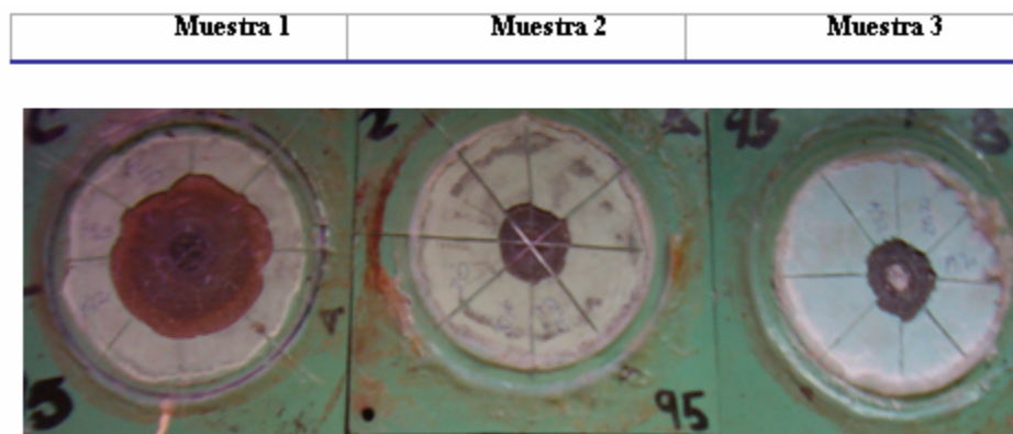
Figura 4.16 Fotos digitales de las probetas con espesor de revestimiento igual a 28 mp, después de evaluar la pérdida de adherencia.
