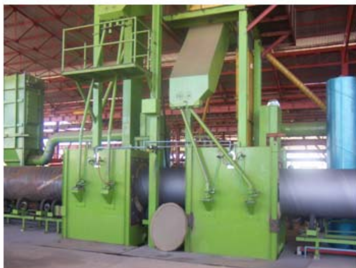
Figura 2.9. Etapa de preparación de la superficie, granallado externo.
