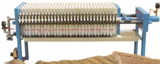
**Figura 2.8 Filtro prensa de placas y marcos (Garcés y col, 1996).**
