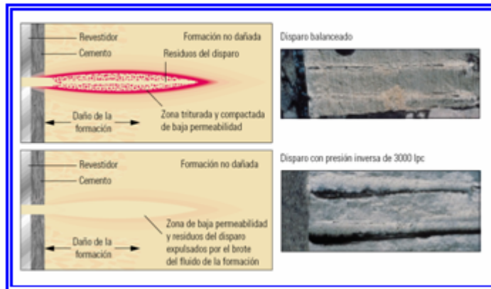
Figura 4.4. Penetración Parcial por Cañonamiento.
