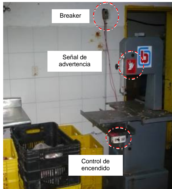
Figura 4.2. Estación de trabajo de cortes
