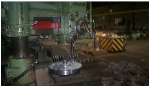
Figura 4.4. Mecanizado del bonete.
