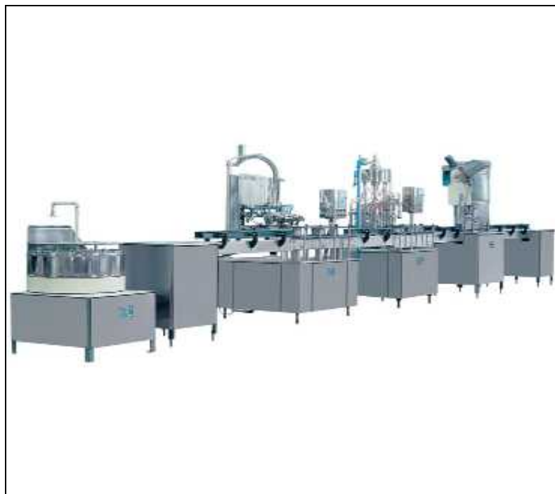
Figura n° 9 Línea de envasado (enjuagado, llenado y taponado de botellas)
