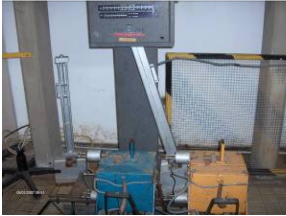
Figura 4.7. Máquina de Impacto. Fuente: elaboración propia
