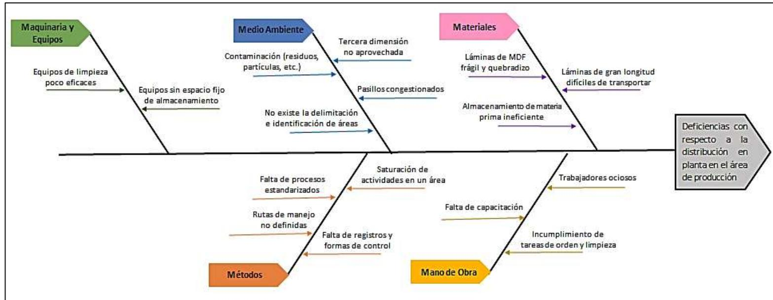
Figura 5.1 Diagrama de Ishikawa aplicado al área de producción con respecto a su distribución en planta. (Elaboración propia, 2023)
