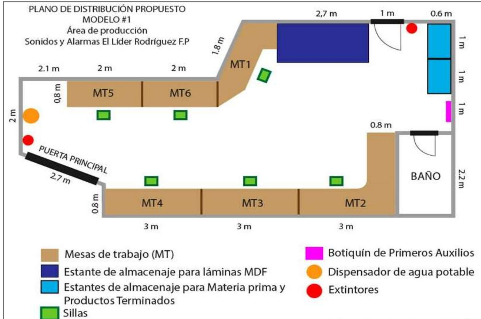
Figura 6.4 Alternativa modelo #1 de la distribución en planta propuesto. (Elaboración propia, 2024)
