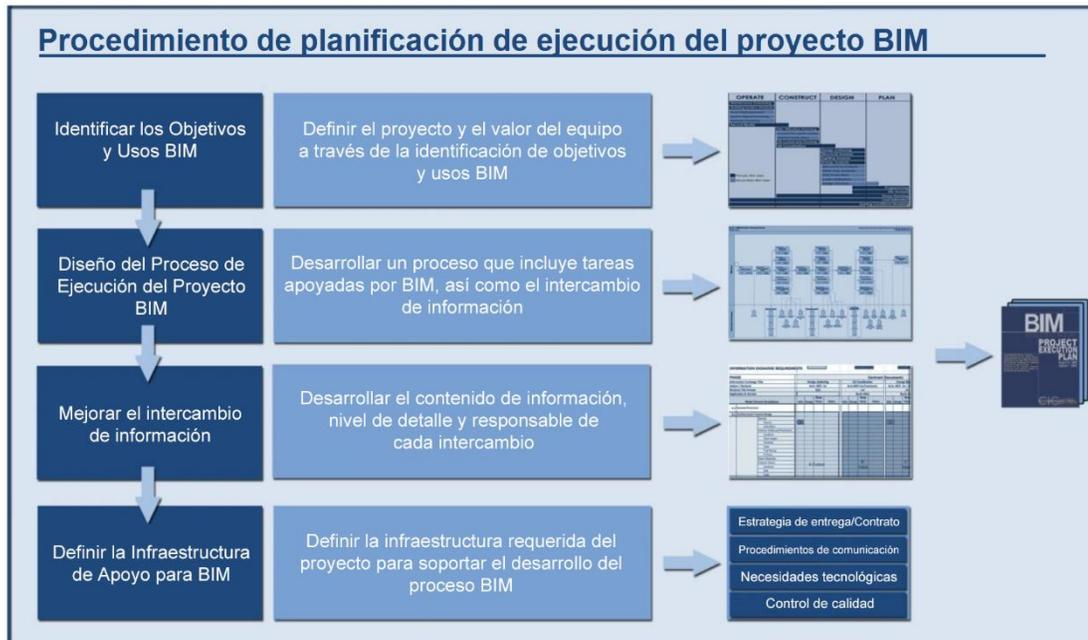
Figura 1. Procedimiento de planificación de ejecución del proyecto BIM.
