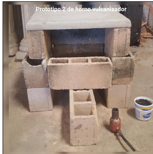
Figura 6 Prototipo 2 de horno vulcanizador hecho con bloques y tapa de Magnesita
