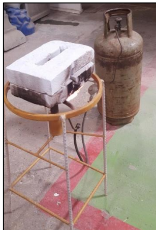
Figura 5 Prototipo 1 Horno vulcanizador hecho de Magnesita
