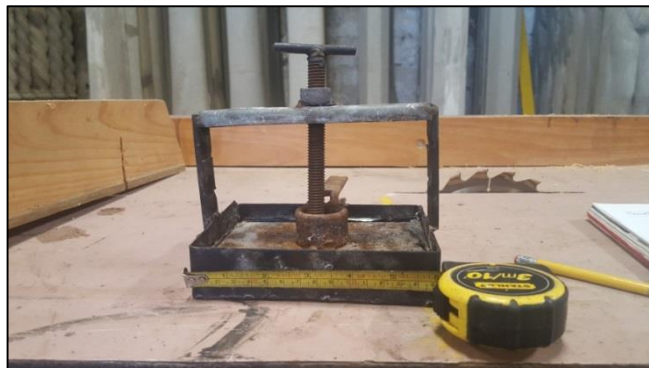
Figura 4 Matriz o molde metálico
