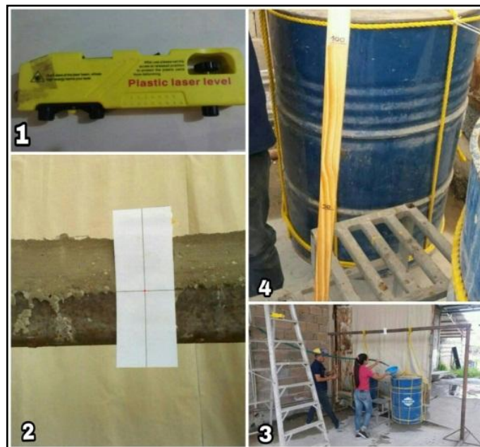
Figura 7. Ensayo de las vigas mixtas. 1) Nivel con láser incorporado para medir la deflexión, 2) Hoja guía o patrón de medición, 3) Esquema del ensayo, 4) Regla graduada para medir los litros de agua. Fuente: Autores.
