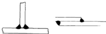
**Figura 3.** Soldadura de filete. **Fuente:** Diseño de acero estructura. Bowles (1.993)
