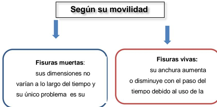
Figura N° 9. Clasificación de la fisura en cuanto a su comportamiento
