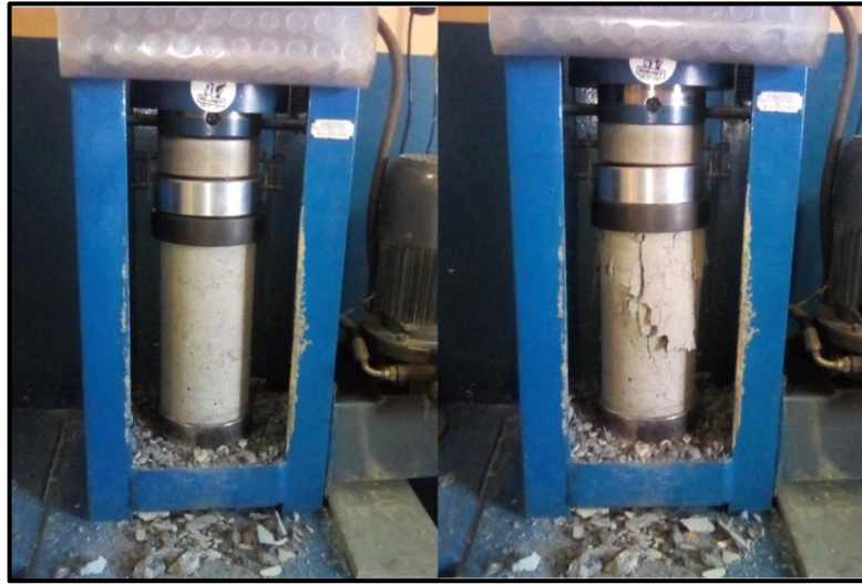
Figura 17. Ensayo de compresión Fuente: autores (2018)
