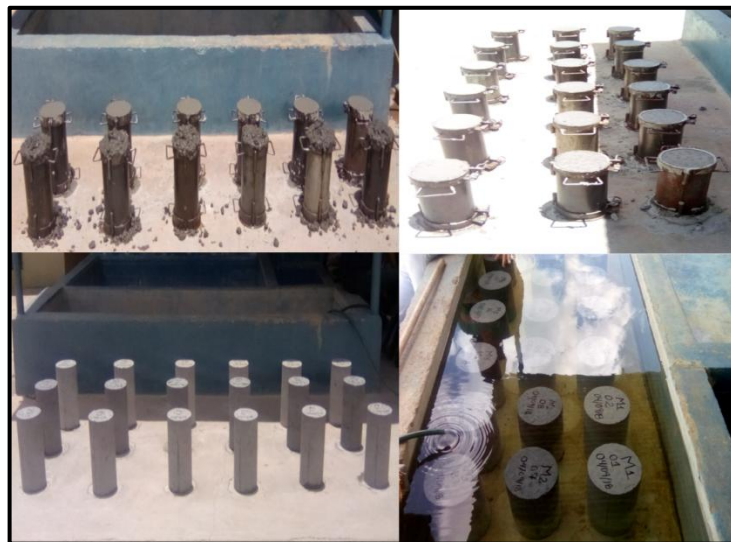
Figura 14. Elaboración y curado de probetas cilíndricas de concreto Fuente: autores (2018)
