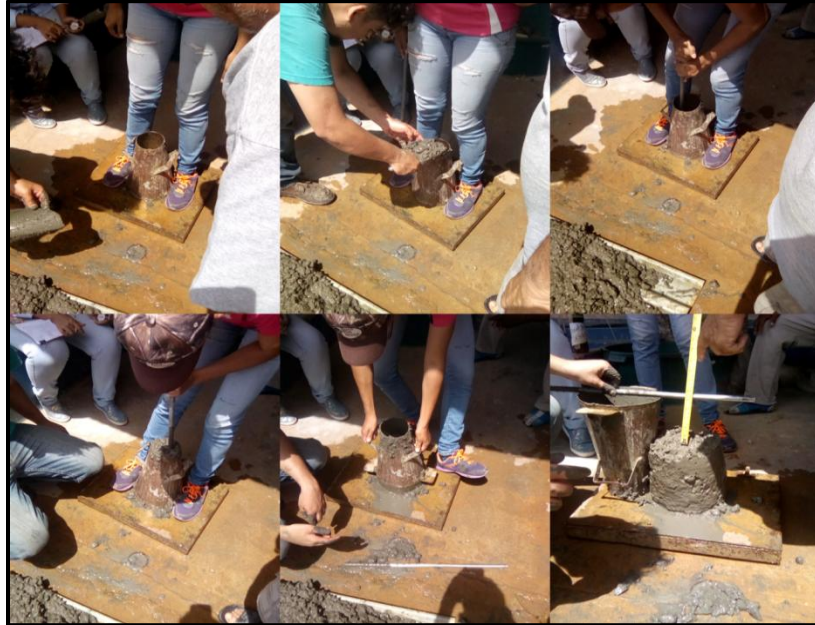
Figura 13. Medición del asentamiento Fuente: autores (2018)
