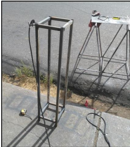
Figura 14. Confeccionamiento del soporte estructural.
