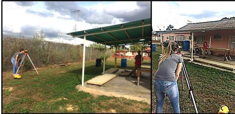
Figura 11. Medición de las elevaciones, para determinar la deflexión en las losas.
