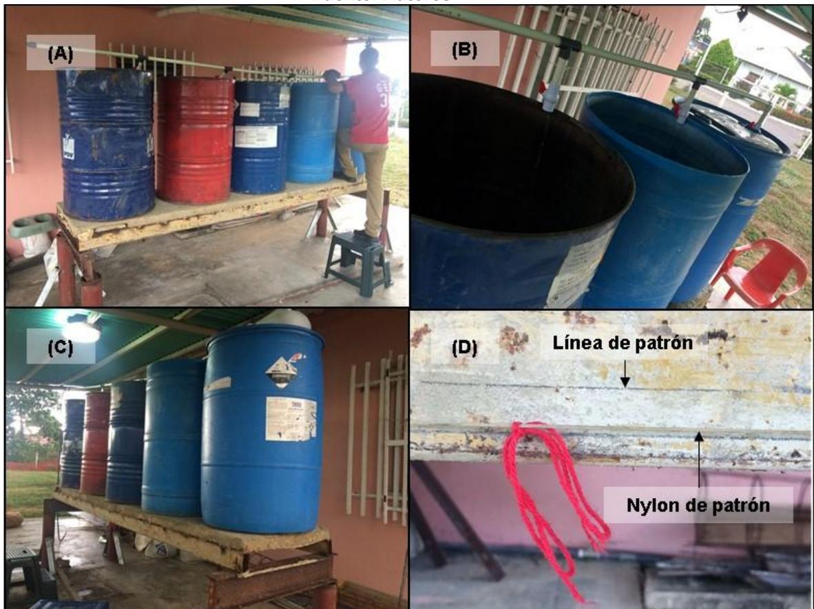
Figura 12. Ensayo de las losas. A) Instalación de cabezal de llenado, B) y C) Llenado de tambores, D) Medición inicial de flecha. Fuente: Autores
