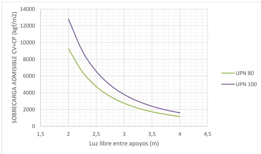
**Figura 19. Nomogramas relación carga-luz libre para perfiles UPN y  $t_c= 8\text{cm}$ . Fuente: Autores.**
