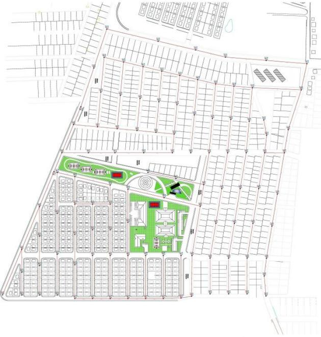
Figura 8: Trazado del sistema de recolección de aguas servidas.
