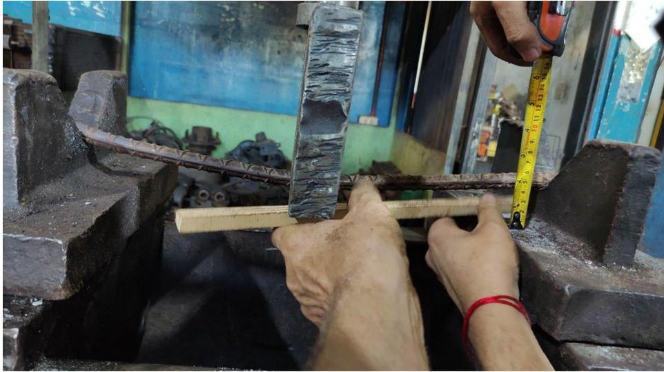
Figura 4.12 Deflexión de probeta de acero larga.
