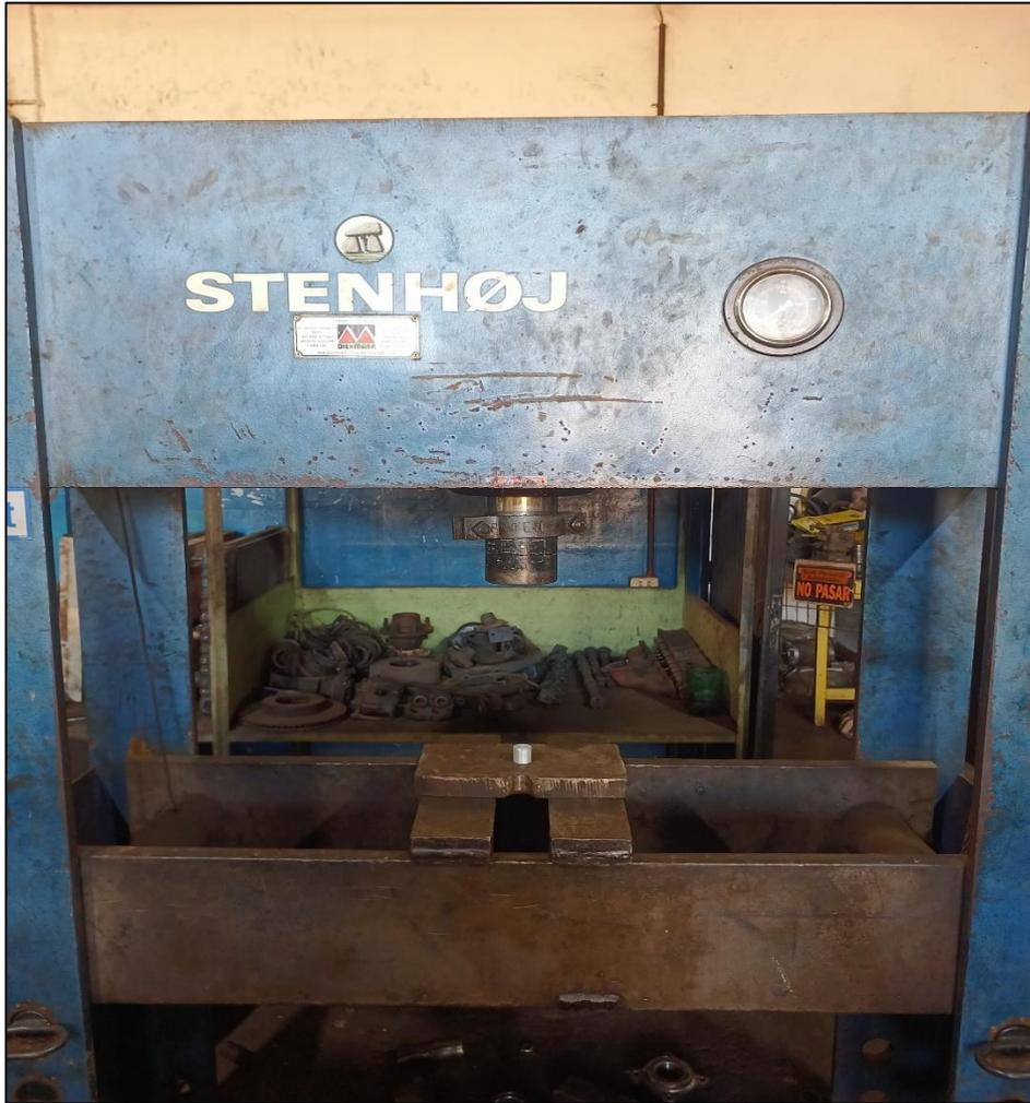
Figura A.3 Colocación de la probeta de aluminio en la base fija de la prensa hidráulica.
