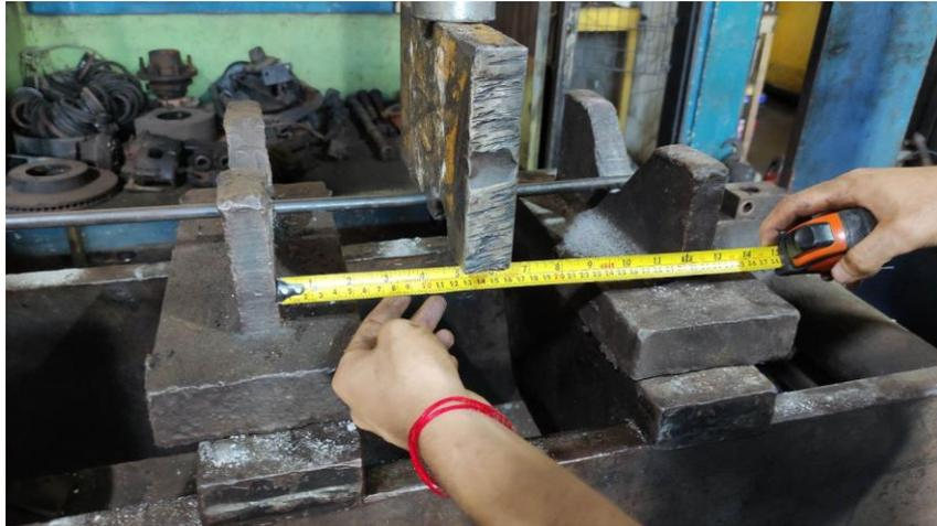
Figura 4.8 Colocación de probeta de acero corta en la prensa
