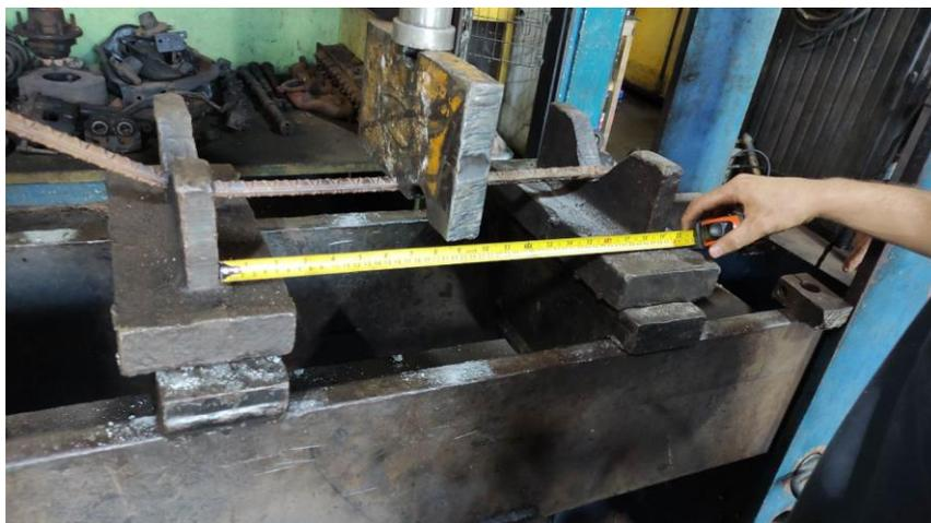
Figura 4.11 Colocación de probeta de acero larga en la prensa
