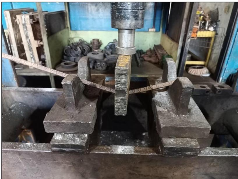
Figura 4.9 Deflexión de probeta de acero corta
