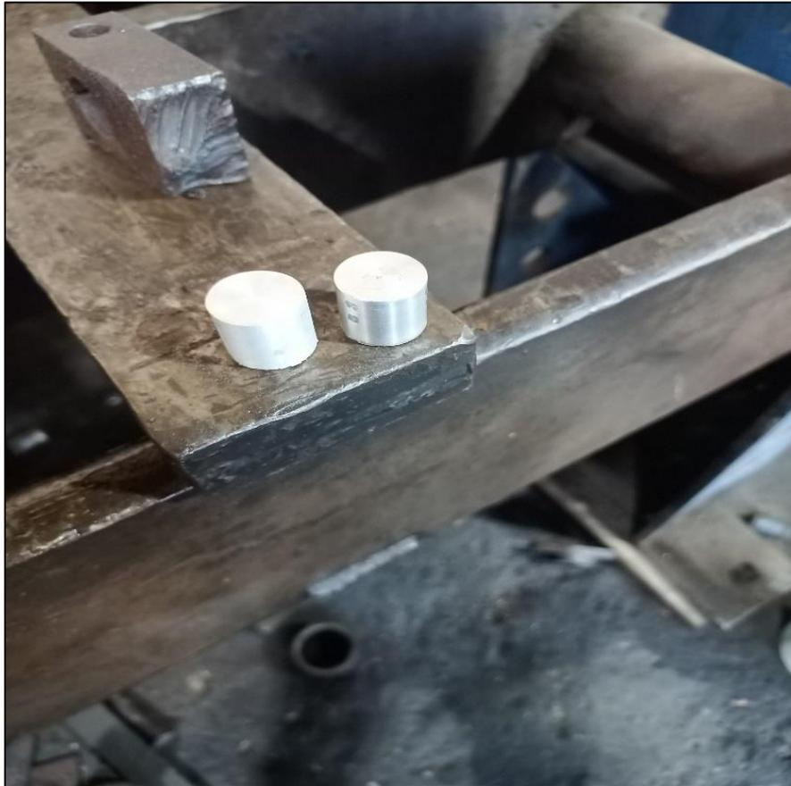
Figura 4.1 Probetas de aluminio.
