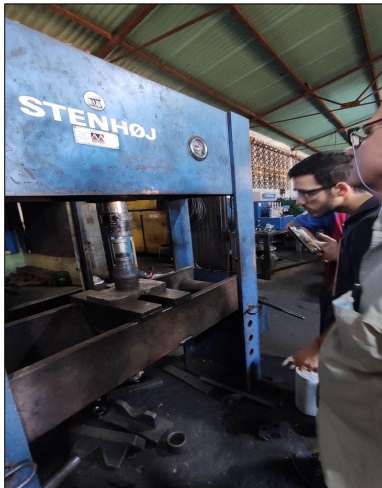
Figura 4.3 Aplicación de la carga de aplastamiento.
