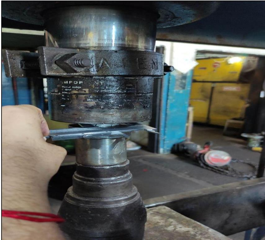
Figura 4.4 Fractura por efecto de abarrilamiento.
