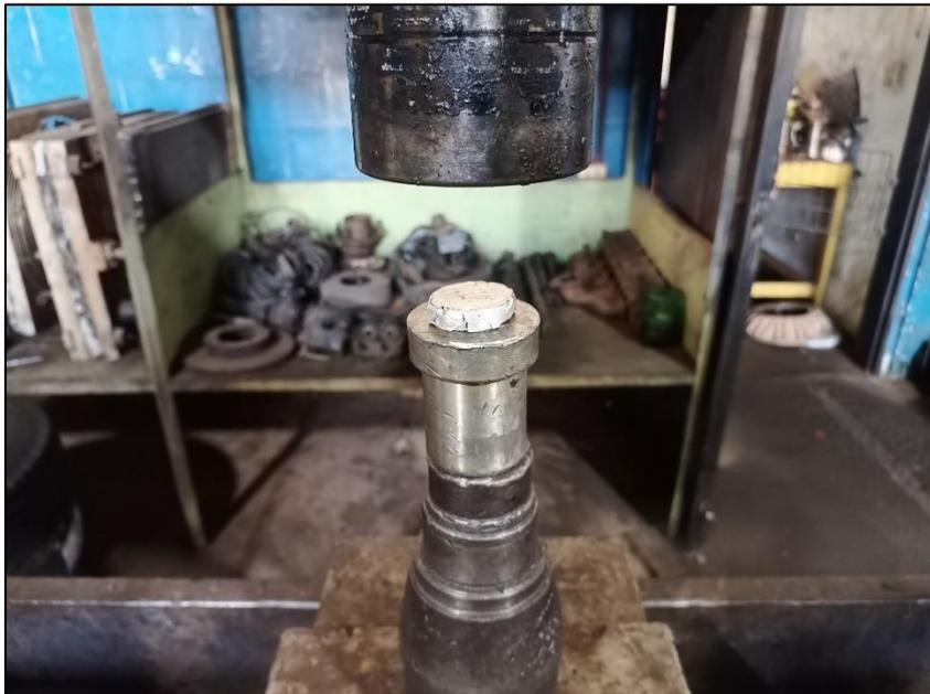
Figura 4.5 Ensayo finalizado, probeta fracturada.
