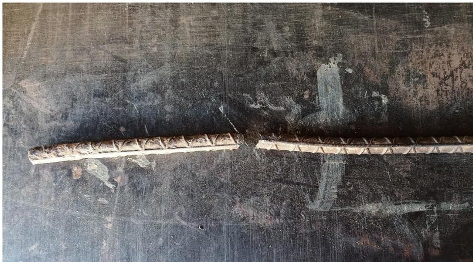
Figura 4.13 Rotura de la probeta larga.
