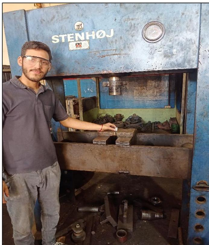
Figura 4.2 Colocación y centrado de la probeta en la prensa.
