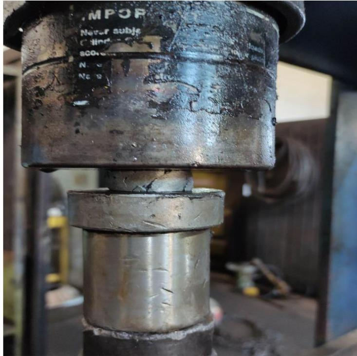
Figura 5.1 Deformacion tipo abarrilamiento con grieta
