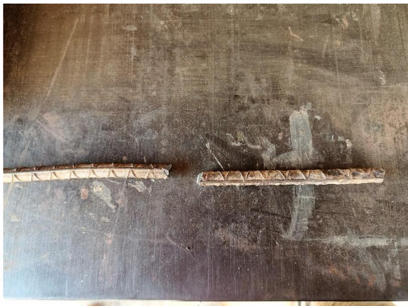
Figura 4.10 Rotura de la probeta corta
