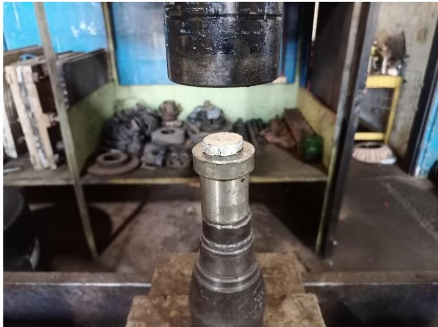
Figura 5.2 Pieza de aluminio con una deformacion final agrietada
